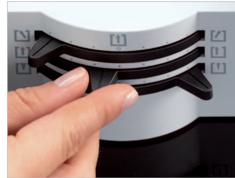
Mit drei Schiebereglern verändern Sie die Position des Spiegels zum Objekt.
