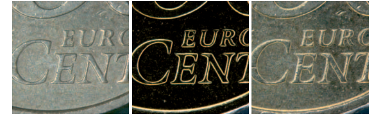
Auflicht-Hellfeld, Viertelkreis Auflicht-Dunkelfeld, Vollkreis Mischlicht
