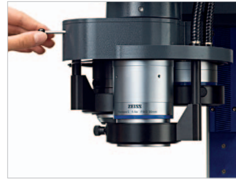
Der Objektivrevolver Koax S 3x3 cod vereint eine koaxiale Hellfeldbeleuchtung mit einem 3-fach Objektivrevolver. Über eine Zugstange schwenken Sie die koaxiale Beleuchtung aus.
