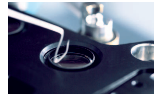
... übernimmt ein beweglicher Mikro-Klöppel des computergesteuerten Richtklebeautomaten selbständig die Feinjustierung.
