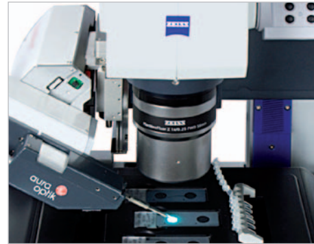
Mit dem Tischaufsatz 6X und Platte Slides/Tubes 6X 237x157mm isolieren Sie Spermien aus einem Zellgemisch und transferieren diese in Tubes.
