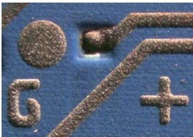
Leiterplatte Seitlich streifendes Auflicht Objektiv: Plan S 1,0x Vergrößerung: 16x*
